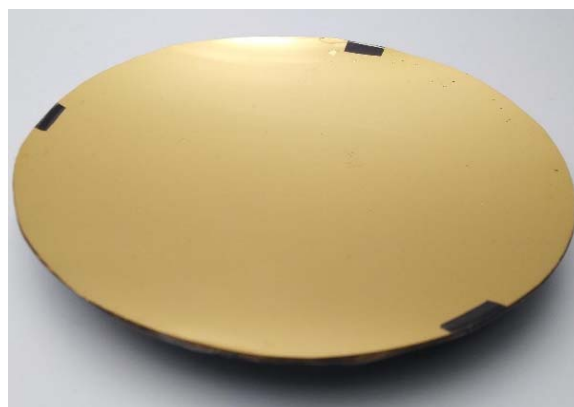
Prototipo di specchio in fibra di carbonio realizzato con diametro 150 mm
