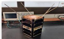
I cubesat sono strumenti di **dimostrazione e qualifica tecnologica**
