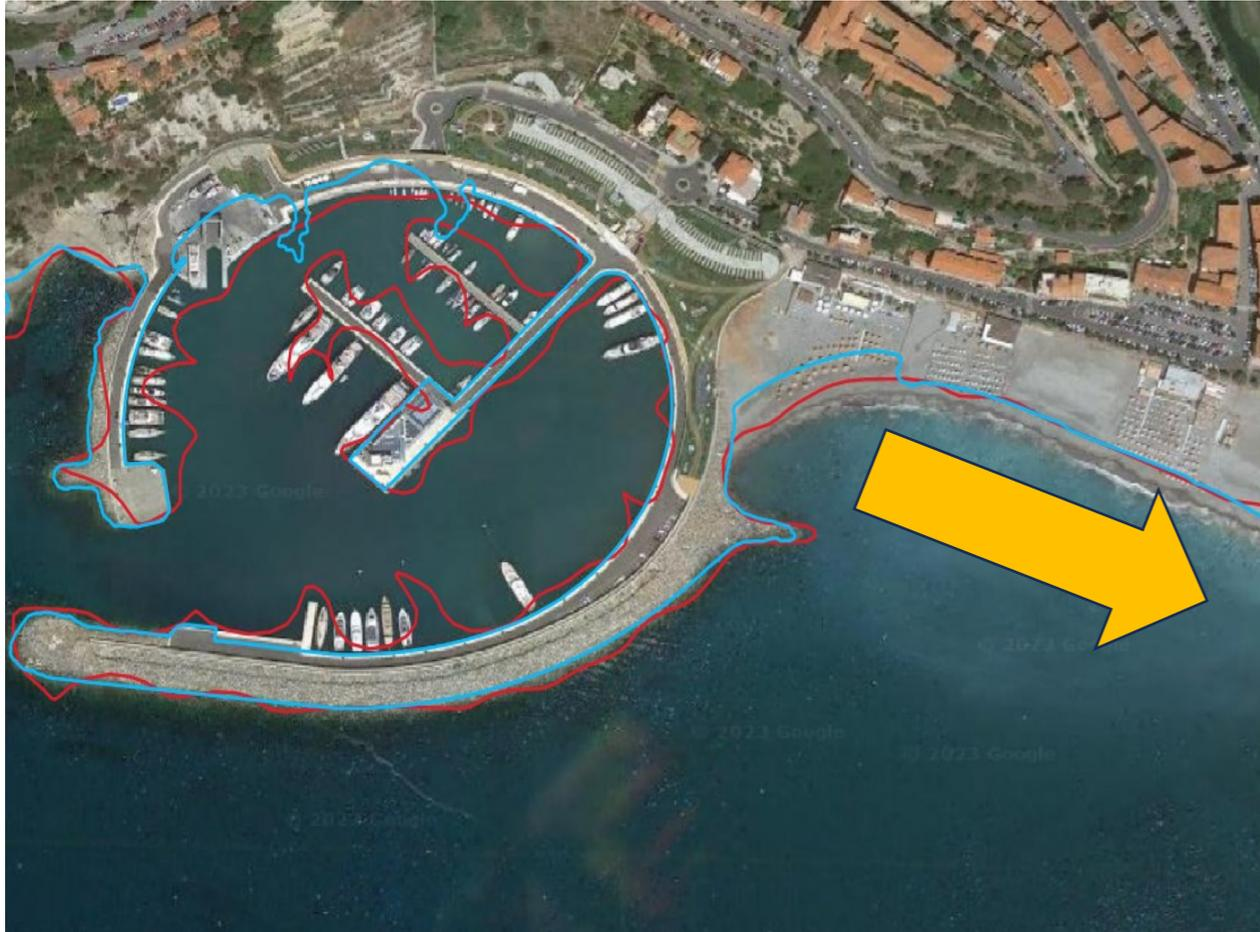
NeMeA ha mappato e monitorato con campagne semestrali (pre momento zero, fine lavori) sia la linea di costa che le batimetriche ingegnerizzando un primo drone acquatico nel lontano 2007, dotato di SONAR/GPS e telecomandato a una distanza di 1km dalla linea di costa.
