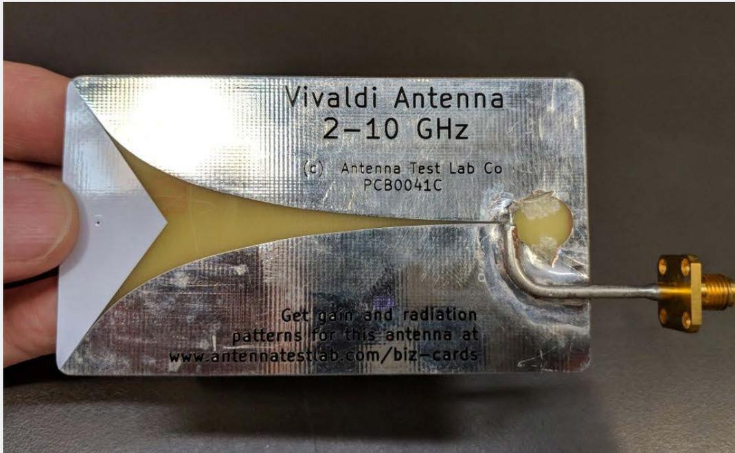
Si tratta di utilizzare dei sensori (antenne), o un array di sensori, di dimensioni centimetriche operanti nel range 1-18 GHz circa e studiarne il segnale trasmesso e ricevuto attraverso il bersaglio. Le caratteristiche di risoluzione spaziale sul piano e in profondità sono definite dalle caratteristiche delle antenne.
