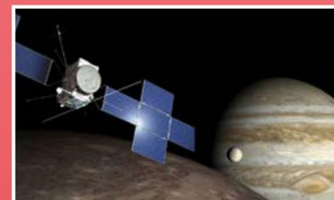
**JUICE**, missione ESA dedicata allo studio delle lune ghiacciate di Giove (Ganimede, Callisto ed Europa). L'ASI ha realizzato e consegnato ad ESA gli strumenti: RIME (radar sottosuperficiale), 3GM (strumento di radioscienza) e HAA (accelerometro); sono sotto test JANUS (camera ad alta risoluzione) e MAJIS (spettrometro ad immagine). Il lancio è pianificato nel 2022.
