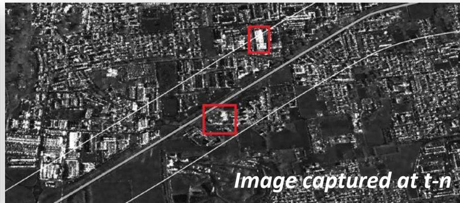
Quando si fa interferometria, di fatto, si sta facendo “change detection” su dati di fase... I dati di *ampiezza* (sempre disponibili) possono essere utilizzati con successo per il monitoraggio di alcune tipologie di interferenze lungo l’infrastruttura d’interesse.
