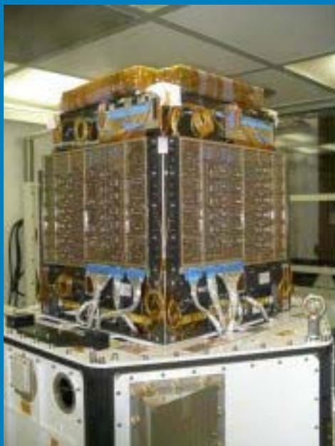
Il Gamma Ray Imaging Detector (GRID) imbarcato sul satellite AGILE
