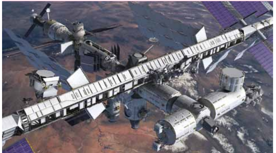
Il rivelatore AMS-02 agganciato alla Stazione Spaziale Internazionale. L'Alpha Magnetic Spectrometer, conosciuto come 'cacciatore di anti-materia', è stato progettato per la ricerca di nuovi tipi di particelle – antimateria, materia oscura, materia strana – tramite la misura ad alta precisione della composizione dei raggi cosmici
