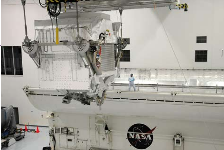
Le operazioni di carico dell'AMS-02 nella 'pancia' dello Shuttle Endeavour al Kennedy Space Center
