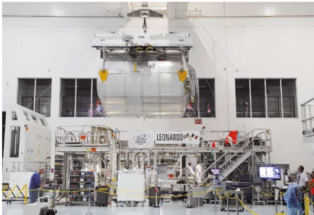
Una delle fasi di installazione di PMM nel canister per il trasporto alla rampa di lancio
