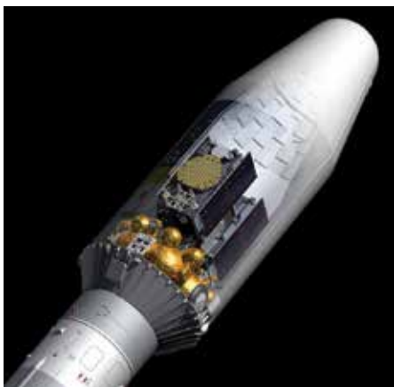
Rappresentazione del vettore Soyuz modificato per il trasporto di due satelliti Galileo
